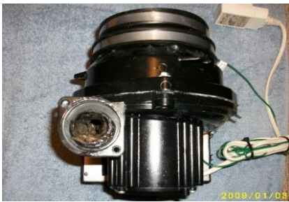
排水路の詰まり
